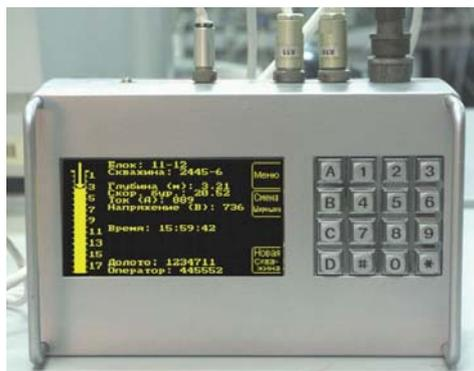
Рис. 4. Общий вид контроллера бурового станка КОБУС.
